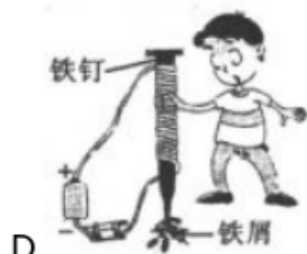
D. 自制电磁铁
